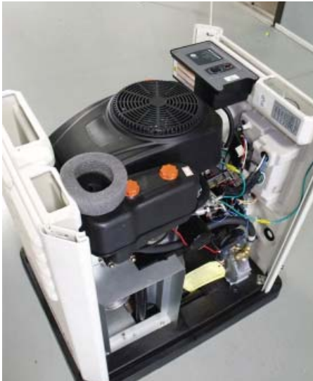
Figure 1.3 — Enlever les panneaux latéraux
