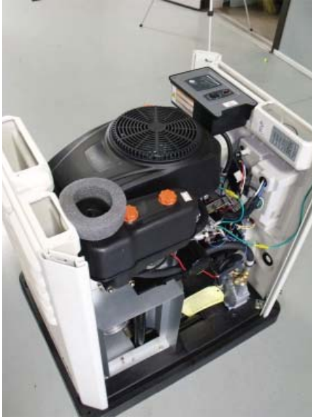
Figura 1.3 — Retire los paneles laterales
